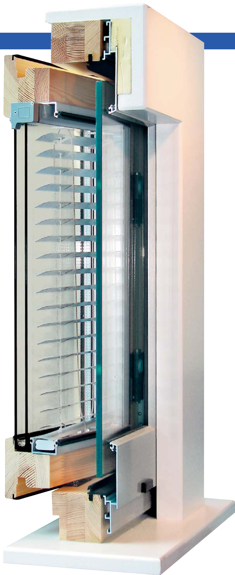
Coupe du système de fenêtre Nestle Novum K1 (double vitrage isolant) avec store en aluminium.
